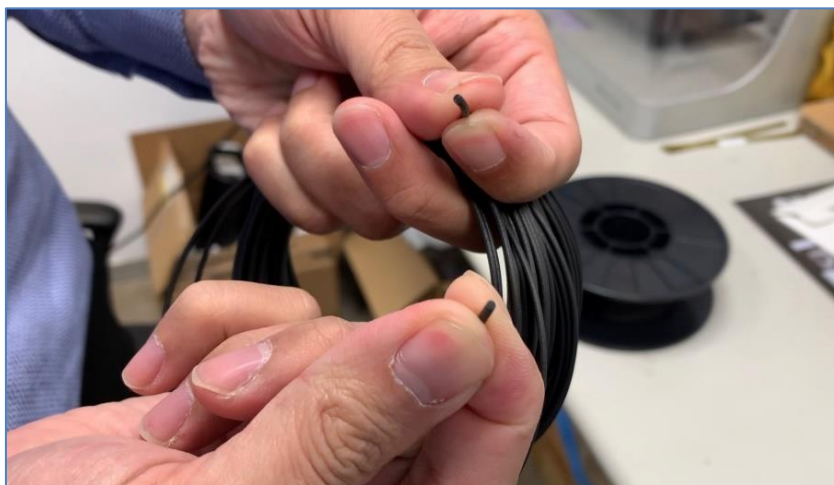
圖 3 良好的 Onyx 材料可以簡單的彎折破壞
