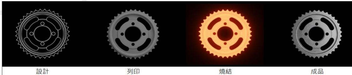
圖 .10 Metal X 模型製作流程
